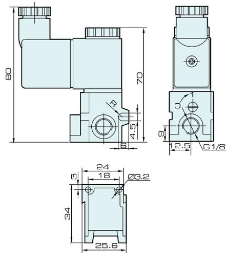
• Dimensional da Válvula **VGM3** montada modular.
