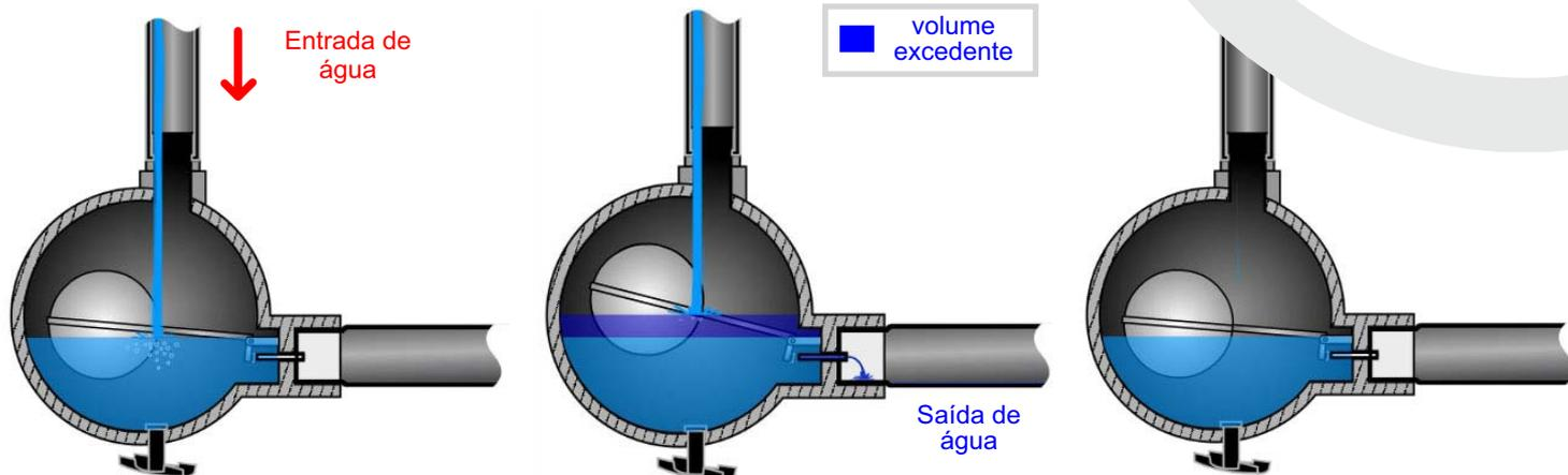
Dentro do dreno há uma bóia, que monitora o nível de água. Conforme o dreno acumula líquido, essa sobe até certo nível.
