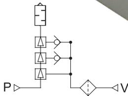
**Incremento de 250% na vazão de sucção e redução de 20% no consumo de ar, devido aos 3 estágios.**
